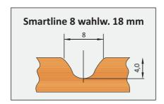
Mit Nutboden "Fineline CI" für optimales Nuten und Abplatten (CI bedeutet farbgleicher Nutgrund abgestimmt auf Oberfläche)
